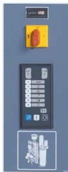
**Винтовые компрессоры GENESIS и FORMULA в стандартной комплектации оснащаются интеллектуальными электронными блоками управления MC<sup>2</sup>.**
