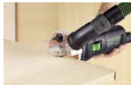
Фрезерование пластмассовой или деревянной кромки заподлицо.
