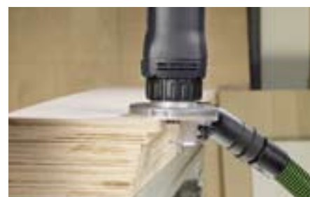
Фрезерование пластмассовой или деревянной кромки.
