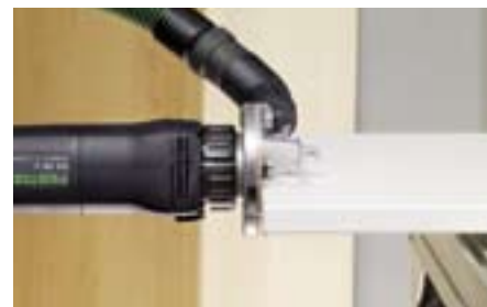
Скругление пластмассовой или деревянной кромки.
