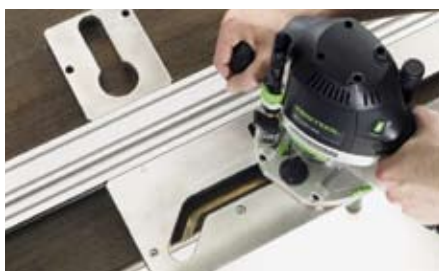
С помощью фрезерного шаблона для рабочих плит последовательно изготавливаются угловые соединения кухонных панелей.
