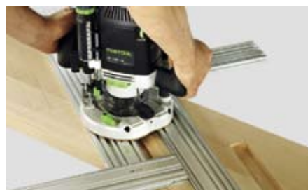
С помощью MFS можно так же точно фрезеровать пазы под ступени в тетиве лестницы.
