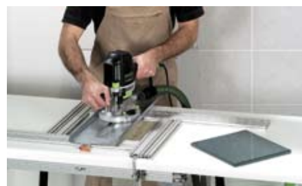
Фрезерные салазки MFS-FS позволяют просто и чисто работать фрезером на плоской поверхности.
