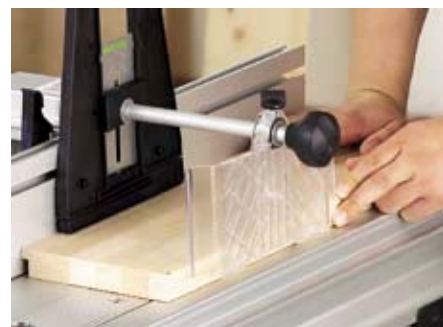
С помощью фрезерного модуля CMS и подходящей фрезы можно легко фрезеровать различные формы.
