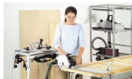
В стационарном режиме или на шине-направляющей: погружные пилы быстро демонтируются и в обоих вариантах готовы продемонстрировать свои сильные стороны.
