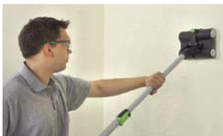
Регулировка глубины защищает грунтовое покрытие от повреждений.
