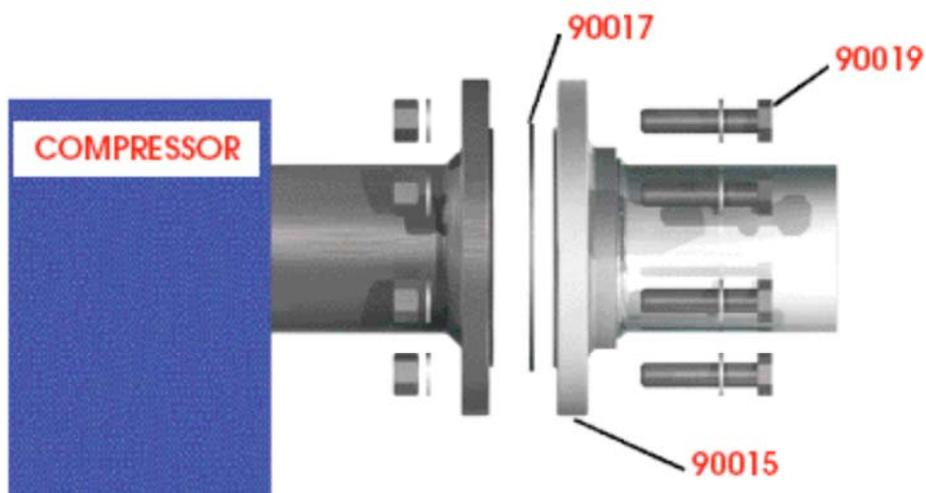
Для соединения пневмосети с компрессором используйте фланцевый адаптер 90015.
