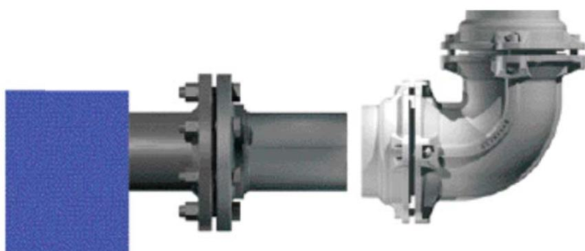
Установите прокладку арт. 90017 между фланцем компрессора и деталью 90015. Фланцы необходимо соединить между собой с помощью комплекта 90019. Момент затяжки болтов 60 Нм.
