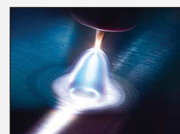
ActivArc - контроль тепловложений при изменении длины дуги
