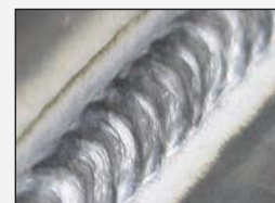
Технология Super Puls при MIG/MAG сварке: обеспечивает внешний вид TIG соединения (чешуйчатый шов)
