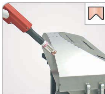
Угловой шов Прихватка на корпусе электрошкафа
