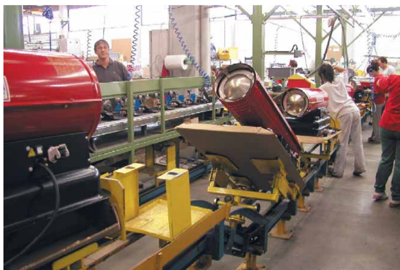
Производственная линия жидкотопливных генераторов горячего воздуха.
