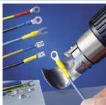
Усадка изоляции кабеля
