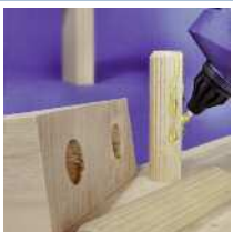
Склеивание деревянных конструкций
