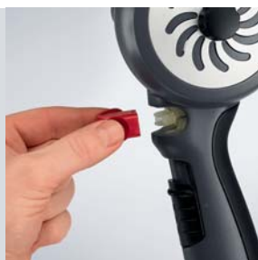
Температура устанавливается вставляемыми переключателями-фиксаторами
