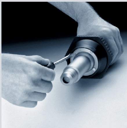
Нагревательный элемент термовоздуходувки можно быстро заменить всего в несколько движений.
