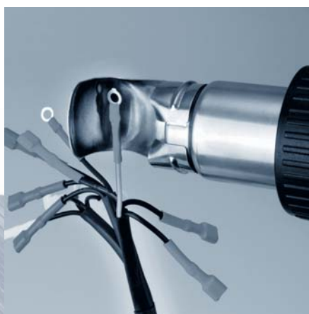
Термоусадка изоляции кабеля
